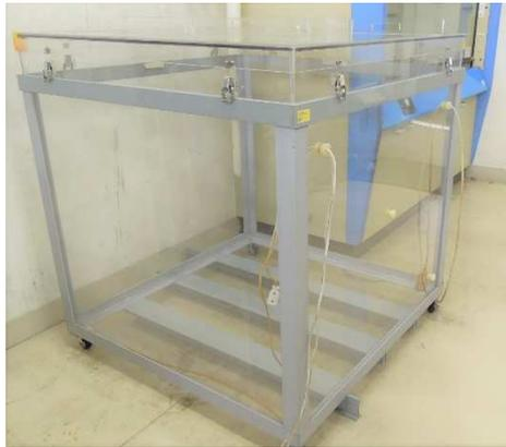
空気清浄機に対する脱臭効果試験として、1 m<sup>3</sup>の密閉容器(アクリル樹脂製)を使用した試験を承っております。
